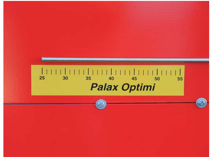
2. Die Schnittlängen kann für Scheitlängen von 25–55 cm optimal eingestellt werden.
